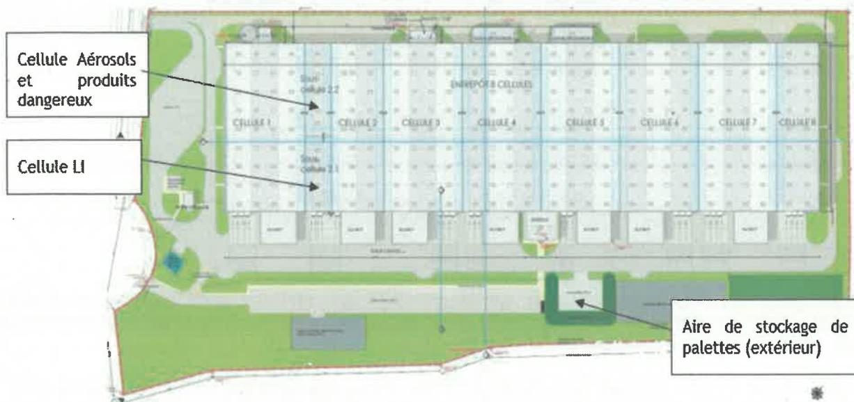
Ce compartimentage a pour objet de prévenir la propagation d'un incendie d'une cellule de stockage à l'autre. Pour atteindre cet objectif, les cellules respectent au minimum les dispositions suivantes :
