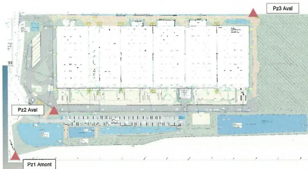
Ces ouvrages seront nivelés, après réalisation, afin de vérifier le sens d'écoulement réel de la nappe de la craie. L'implantation des piézomètres est réalisée selon les recommandations d'un hydrogéologue expert.
